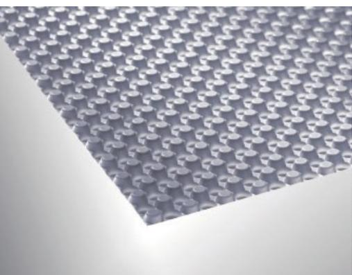
Ямки среднего слоя расположены по обе стороны и имеют небольшую общую высоту, что обеспечивает чрезвычайно высокую прочность на сжатие. Небольшая высота обеспечивается равномерным распределением высоты вершин ямок, что позволяет прочно приваривать средний слой к верхним слоям.
